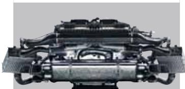
Der 6-Zylinder-Boxermotor ist in Leichtmetallbauweise gefertigt. Das geringe Gewicht des Motors erhöht die Agilität und senkt den Verbrauch.
